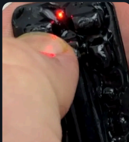
3. Под напряжением, работает под водой
